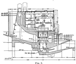
Salle des machines de l'usine du Verbois. Coupe transversale. Alternateur 27 500 kVA. Turbine 23 200 kW pour  $H_{\rm m}=20.80$  m et Q=127.50 m³/s.
