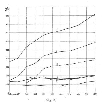
Energieabgabe 1930 bis 1940. 1 Jahrestotal. 2 Wärmetotal. 2H Wärmehochtarif. 2N Wärmeniedertarif. 3 Licht. 4 Motoren.
