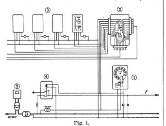
Sender im Betriebsbureau. 1 Impulsgeber. 2 Schrittsteuerrelais. 3 Rückmeldeanlage. 4 Netzschütz. 5 Zähler. F Steuerdraht.
