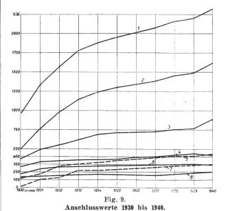
1 Total. 2 Wärme. 3 Haushalt-Apparate. 4 Motoren. 5 Kochherde. 6 Licht, 7 Heisswasserspeicher. 8 Spitzenbelastung der Abgabe (blieb trotz mehr als verdoppeltem Anschlusswert praktisch konstant).
