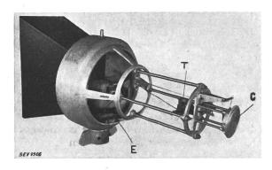
Fig. 6. Aktiver Teil eines elektrostatischen Voltmeters für eine Million V mit eingebautem induktionsdynamo-metrischen Geber. Projektionslampe Geber Bewegliche Elektrode
