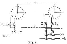
Grundsätzliche Anordnung einer Fernsteuereinrichtung mit mehrstelligem Auswahlzeichen.
