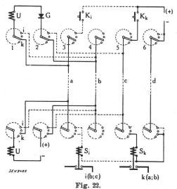
Grundsätzliche Anordnung einer Wählerfernsteuerung mit Leitungskombination und Ruhestromüberwachung.
