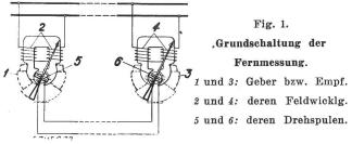
Ein zweites gleiches Elektrodynamometer 3 ist das Empfangsinstrument. Ihre Feldwicklungen 2 und 4 werden aus derselben Wechselstromquelle gespeist; sie können unter sich in Reihe oder parallel zueinander geschaltet sein. Die beiden Drehspulen 5 und 6 sind durch zwei Leiter zu einem Stromkreis für sich vereinigt.
