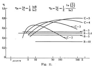
Wirkungsgrad von Schaltungen nach dem Potenz- und Kombinationsgesetz.
