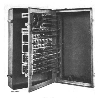
Fig. 15. Wählergerät nach Fig. 14, mit herausgedrehtem Relaisrahmen.
