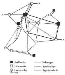
Fig. 1. Elektrizitäts-Versorgungsbetrieb mit fernwirktechnischen Einflusslinien.
