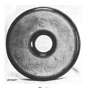
Widerstand älterer Bauart, 1500 A Nennableitvermögen.
