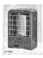
Description: Radiateur électrique selon figure. Trois corps de chauffe verticaux sont montés de front devant un réflecteur et protégés par un dispositif en tôle perforée, ouvert vers l'arrière. Le bâti en tôle est ventilé et possède des poignées en matière isolante. Un interrupteur de réglage permet de faire fonctionner le radiateur au 1/3, 2/3 ou 3/3 de la puissance de chauffe. Une fiche d'appareil sert au raccordement du cordon d'alimentation.
