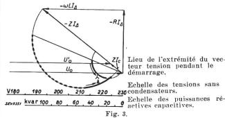
Diagramme des tensions pendant le démarrage d'un moteur de 14,7 kW (20 ch) à l'extrémité d'une ligne aérienne de 400 m de longueur et de 8 mm de diamètre Cu.
