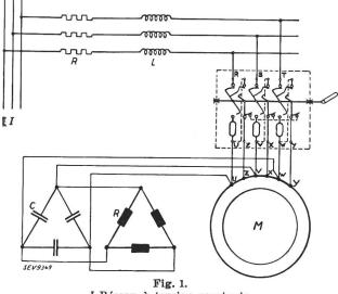
I Réseau à tension constante. C Condensateurs. M Moteur.
