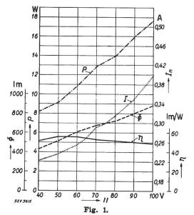
Charakteristische Daten einer Hochfrequenz-Fluoreszenzlampe von 400 Hz. Aufgenommene Leistung P, Strom I, Lichtstrom  $\Phi$ , Lichtausbeute  $\eta$ .
