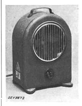
Description: Radiateur électrique avec ventilateur, selon figure. Les résistances spiralées sont disposées sur des isolateurs en porcelaine, dans un boîtier métallique. Derrière ces résistances se trouve un ventilateur entraîné par un moteur monophasé à induit en court-circuit à auto-démarrage. Un interrupteur incorporé perd'enclencher simultanémet ment le ventilateur et le chauffage, ou le ventilateur seulement. Un coupe-circuit thermique interrompt le chauffage dès que la ventilation est in-
