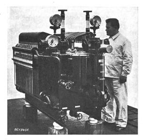
Electrolyseur Oerlikon moderne pour 10 m $^3$  d'hydrogène par heure.
