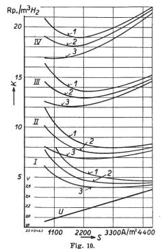
Prix de revient (K, en cts/m³) de l'hydrogène, en fonction de la densité de courant (S) des électrodes pour un électrolyseur de 300 m³ d'hydrogène par heure.
