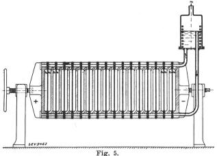
Fig. 5. Electrolyseur système Oerlikon-Schmidt.
