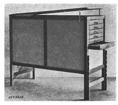
Description: Séchoir électrique en bois et en éternite selon figure. L'appareil possède six tiroirs à treillis avec cadre en bois, pour contenir les matières à sécher. Le couvercle, mobile, ne peut être fermé complètement.
