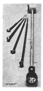
Description: Dispositif selon figure, pour le raccordement de machines transportables à des lignes aériennes triphasées avec neutre. Cet appareil se compose de quatre bornes de connexion, d'un coffret de coupe-circuit, d'une prise et de lignes de jonction. Les poteaux de la ligne aérienne, aux environs desquels un raccordement est prévu, sont munis de deux supports, auxquels le dispositif peut se fixer facilement.
