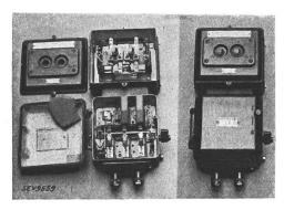
Description: Disjoncteur de protection contre les contacts accidentels selon figure, composé d'un interrupteur de protection tripolaire pour moteurs, muni de déclencheurs thermiques chauffés directement et d'un dispositif de contrôle ayant deux contacts à poussoir et deux résistances additionnelles. Le coffret est en fonte de métal léger.
