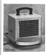
Description: Radiateur muni d'un ventilateur, selon figure. Résistances en boudin parallèles, disposées verticalement. Un ventilateur, entraîné par un moteur série monophasé, est placé derrière le corps de chauffe. Le raccordement au réseau s'effectue au moyen d'un cordon à gaine de caoutchouc à 3 conducteurs. L'appareil possède un interrupteur à bascule unipolaire et un coupe-circuit thermique encastrés.
