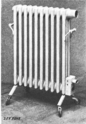
**Description:** Radiateur électrique selon figure, composé de 10 éléments remplis d'eau. Le corps de chauffe est monté dans la partie inférieure de l'appareil. Un interrupteur de réglage permet de faire fonctionner le radiateur à pleine ou demi charge. Une fiche d'appareil sert au raccordement du cordon d'alimentation.
