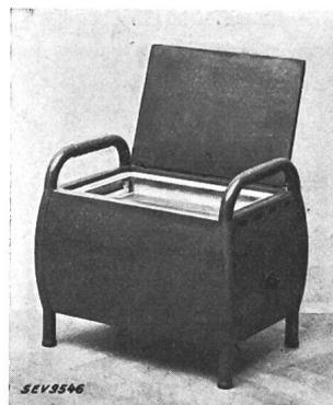
*Description:* Appareil de chauffage électrique selon figure, pouvant fonctionner comme radiateur ou séchoir, construit principalement en tôle. La résistance de chauffe est montée dans la partie inférieure de la caisse métallique. Un commutateur incorporé permet de faire fonctionner l'appareil sous trois puissances de chauffe différentes. Le dispositif de séchage est pourvu de quatre grilles. Pour le séchage, l'appareil ne doit être utilisé que sur la position 1
