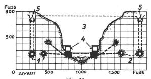
Fig. 13. Grundriss und Querschnitt des Boulder-Kraftwerkes.  $H=178,5...127~\mathrm{m}.$
