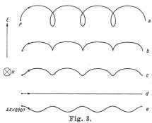
Bahnen eines Elektrons in homogenen elektrischen und magnetischen Feldern, die senkrecht aufeinander stehen, bei verschiedenen Anfangsbedingungen:
