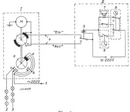
Fig. 1. Vereinfachtes Schema für die kombinierte Steuerung der Strassenbeleuchtung mit Photozelle und Schaltuhr. Schaltstelle.
