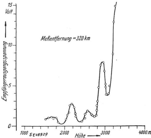
Fig. 10. Durch Sekundärstrahlung zerspaltenes Diagramm. 12. 7. 1935.
