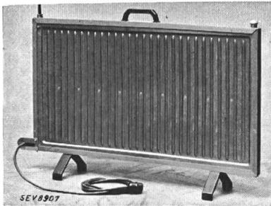
**Description:** Radiateur électrique selon figure. Récipient de forme plate en tôle d'aluminium, rempli d'eau. Corps de chauffe monté dans la partie inférieure de l'appareil. Une poignée en matière isolante, une ouverture de remplissage et un indicateur du niveau de l'eau sont placés sur la partie supérieure du cadre. Raccordement au réseau au moyen d'un cordon à gaine de caoutchouc à 3 conducteurs, muni d'une fiche.
