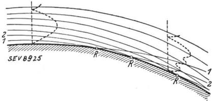
Fig. 6. Schematische Darstellung der Diagrammverzerrung durch Sekundärreflexion.
