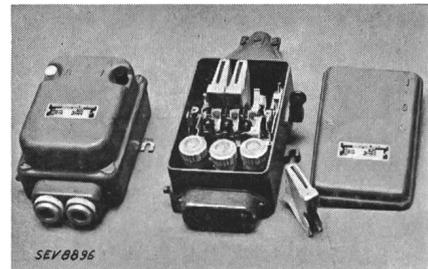
*Description:* Interrupteurs de protection triphasés pour moteurs dans coffrets en fonte, selon figure. Déclencheurs thermiques, chauffés indirectement, sur les 3 pôles. Les déclencheurs peuvent être réglés au moyen d'un tournevis. Contacts tournants en cuivre avec plaquette d'argent aux points de contact.
