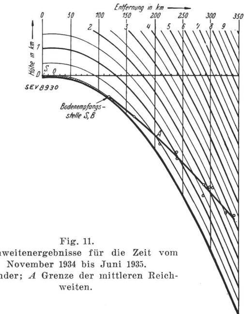
Fig. 11. Reichweitenergebnisse für die Zeit vom November 1934 bis Juni 1935. S Sender; A Grenze der mittleren Reichweiten.
