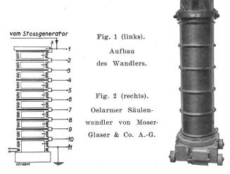
fes eine Erhöhung der Messleistung zur Folge hat. Eine Flusskonzentration im unteren Teil wurde beim Kernsäulenwandler durch eine wesentliche Verstärkung des unteren Jochstumpfes erreicht. Messungen des Leerlaufstromes haben gezeigt, dass dadurch eine nur ganz geringe Zunahme des Leerlaufstromes in Kauf genommen werden muss. Dem oberen Jochstumpf fällt nur die Rolle der kapazitiven Abdekkung der oberen Spulengruppe zu; er kann deshalb in der Höhe gering gehalten werden.
