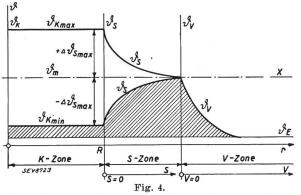
Allure de la température dans l'accumulateur souterrain. Surface hachurée: Investissement de chaleur (période de chauffe). x: Axe des oscillations de la température.
