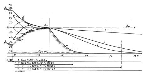
Allure de la température dans les zones d'oscillations et des pertes.
