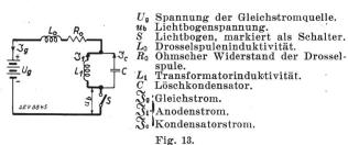
Vereinfachtes Ersatzschema eines Gleichstrom-Wechselstrom-Mutators für ein Berechnungsbeispiel.
