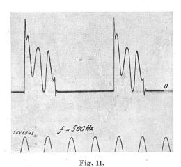
Anodenstrom  $I_a$  (t) nahe der Kippgrenze beim Gleichstrom-Weehselstrom-Mutator.
