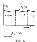
Verlauf des Gleichstromes  $I_0$ und Anodenstromes  $I_1$   $(t) = I_1(t)$ , wenn die Wurzeln p der Operatorgleichung reell sind.
