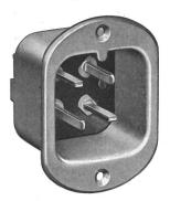
Description: Fiche d'appareil pour montage encastré selon figure. Exécution pour 10 A, 500 V, selon norme SNV 24551. Socle en matière céramique, tiges en laiton, collet de protection en Silumin.
