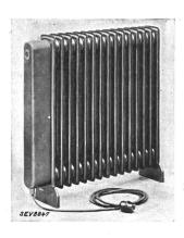
Description: Radiateur électrique selon figure. Radiateur en acier rempli d'huile; corps de chauffe logé dans la partie inférieure du radiateur; régulateur de température, placé dans la partie supérieure. Raccordement au réseau au moyen d'un cordon à gaine de caoutchouc à trois conducteurs, muni d'une fiche.
