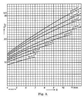
Tension d'essai  $(U_{\rm eff})$  de câbles à ceinture pour un gradient maximum de tension de 4 kV/mm, en fonction de la section et de l'épaisseur d'isolation (b).
