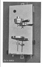
Description: Percolateur pour montage mural selon figure, fonctionnant comme chauffe-eau instantané. L'eau circulant à l'intérieur de l'appareil est en contact direct avec la résistance de chauffe. Le robinet d'eau est couplé avec un interrupteur bipolaire, ce qui évite que l'appareil soit chauffé lorsque le robinet est fermé. Raccordement au réseau au moyen d'un cordon à gaine de caoutchouc à 3 conducteurs mu fiche (2 P + T). muni
