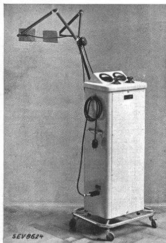
Description: Appareil de thérapie à ondes ultra-courtes, selon figure avec 1 tube à haute fréquence, longueur d'onde 6,55 m. Réglage de l'énergie à haute fréquence par résistance insérée dans le circuit primaire du transformateur de chauffe. Dans le circuit du malade, condensateur variable et ampèremètre pour l'accordage. Puissance dans le circuit du malade, 68 W au maximum.
