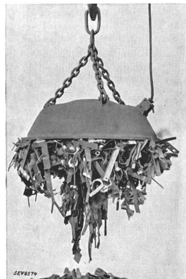
Fig. 5. Lasthebemagnet. Die Windungs isolation besteht aus Aluminium-Oxyd.
