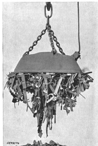
Fig. 5. Lasthebemagnet. Die Windungsisolation besteht aus Aluminium-Oxyd.
