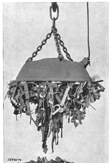
Fig. 5. Lasthebemagnet. Die Windungsisolation besteht aus Aluminium-Oxyd.
