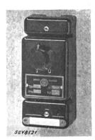
Description: Disjoncteurs d'installation à socle unipolaires, selon figure, à déclenchement thermique et électromagnétique. Commande par bouton tournant. Sectionneur du neutre verrouillé avec couvrebornes inférieur. Socle en matière céramique; protections et bouton en matière isolante moulée.
