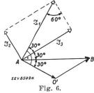
Vektordiagramm bei richtig abgestimmten Schaltungselementen.
