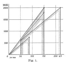
Abschaltleistungen und Nennspannungen verschiedener Schalterbauarten.
