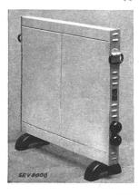
Description: Radiateur électrique transportable, selon figure. Carcasse métallique. Hauteur 780 mm, longueur 810 mm. Deux interrupteurs permettent de chauffer le radiateur à demi ou à pleine charge.
