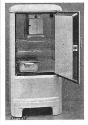
Description: Armoire frigorifique à compression à refroidissement naturel, selon figure. Contenance utile env. 120 dm3. Surface disponible pour les denrées 80 dm2. Revêtement intérieur en tôle émaillée blanche, parois extérieures vernies blanches. Compresseur rotatif et moteur à induit en cage d'écureuil à enroulement auxiliaire montés ensemble dans un carter étanche. Agent réfrigédichlortétrafluorérant: thane (Fréon).
