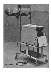
Description: Appareil de thérapie à ondes courtes, selon figure. Deux tubes oscillateurs en push-pull. Système oscillant concentré, à bobines enroulées deux par deux en sens inverse, sans condensateurs.\* Dix touches de puissance. Réglage de la fréquence propre du circuit du malade à l'aide de deux condensateurs variables à bouton de réglage commun. Contrôle du dosage par lampes sof-
