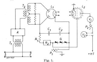
Schéma de principe.
