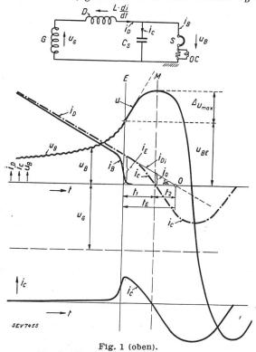
Ersatzschema eines Kurzschlusskreises.
