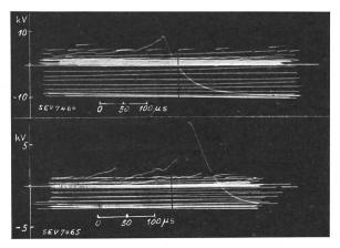
Fig. 10. Abschaltungen mit Parallelwiderstand.
