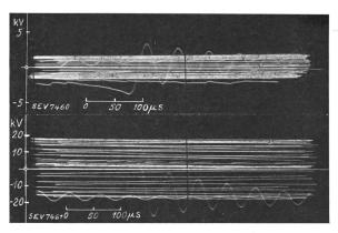
Fig. 6. Einwirkung der Lichtbogenlöscheinrichtung auf die wiederkehrende Spannung.
