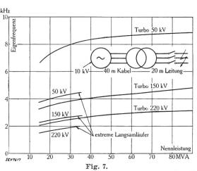
Eigenfrequenzen bei Kurzschlussabschaltungen auf der Oberspannungsseite von Kraftwerktransformatoren.
