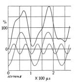
Fig. 4. Wiederkehrende Spannung mit 2 Eigenfrequenzen.
