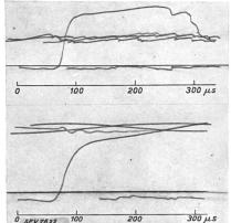
Wiederkehrende Spannung nach einer Kurzschlussabschaltung mit Oelschalter,
