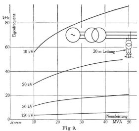
Eigenfrequenzen bei Kurzschlussabschaltungen auf der Sekundärseite eines Transformators, der primärseitig an ein starkes und ausgedehntes Netz angeschlossen ist (bei verschiedenen Sekundärspannungen).
