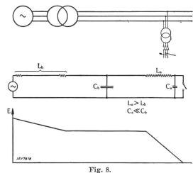
Abzweigleitung mit Transformator.
