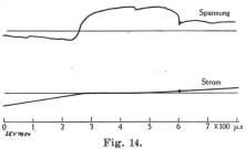
Abschaltversuch mit einem Oelschalter, bei gleichen Daten wie Fig. 10 aufgenommen.
