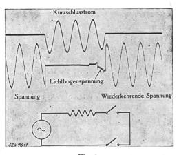
Fig. 1. Schleifenoszillogramm einer Kurzschlussabschaltung.
