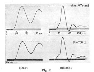
Rückwirkung des Schalters auf den Spannungsverlauf beim normalen und beim indirekten Versuch.
