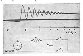
Fig. 2. Kathodenstrahloszillogramm der wiederkehrenden Spannung und Schema des Schwingungskreises.  $f_0=25\,$  kHz.
