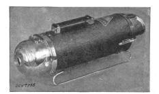
Description: Aspirateurs électriques de poussière selon figure. Ventilateur à force centrifuge entraîné par moteur série monophasé. Appareils munis d'un tube flexible, de tubes de guidage et de différentes embouchures, utilisables pour souffler ou aspirer.
