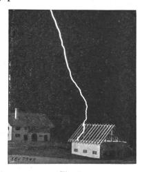
Fig. 5. Décharge sur l'écurie; déchiquetage de la charpente.
