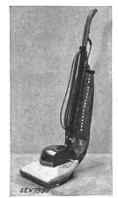
Descriptions: Aspirateurs électriques de poussière selon figure. Ventilateur à force centrifuge, tambour à côtes et brosses rotatives entraînés par moteur série monophasé ventilé. Petite lampe à incandescence montée dans la carcasse.
