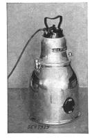
Descriptions: Aspirateurs électriques de poussière selon figure. Ventilateur à force centrifuge à deux étages, entraîné par moteur série monophasé. Appareils munis d'un tube flexible, de tubes de guidage et de différentes embouchures, utilisable pour souffler et pour aspirer.
