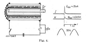
Versuchsanordnung zur Stoßstromprüfung und Oszillogramm.
