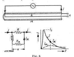
Entstehung einer Längsspannung u zwischen Ader A und Mantel M und Einfluss der Stromverdrängung vom Bleimantel zur Tragdrahtbewehrung.
