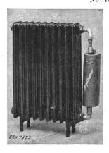
Description: Radiateur de chauffage central avec élément chauffant, selon figure. Les 10 éléments en tôle d'acier qui sont remplis d'eau, ont une surface totale de 2 m<sup>2</sup> environ. Le tube de circulation de l'élément chauffant est émaillé à l'extérieur et revêtu par-dessus de l'enduit conducteur servant de résistance chauffante.
