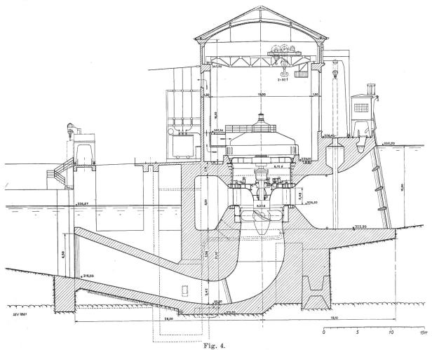
Coupe à travers le bâtiment des machines, échelle: 1:400.
