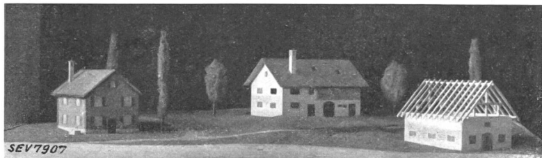
Fig. 10. Maquette d'un groupe de maisons servant aux démonstrations de la foudre dans le laboratoire à haute tension. Les éclairs sont produits par un générateur d'impulsions à 2 000 000 V.
