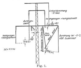
Mastkopffestlegung für Hochspannungsleitungen.
