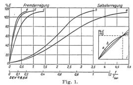
Turbo-Erreger 110 kW, 220 V, 3000 U/min, Erregungsgeschwindigkeiten.
