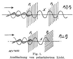
Einfall des gewöhnlichen Lichtes.  $P_1$  Erster Polarisator.  $P_2$  Zweiter Polarisator. x Polarisiertes Licht. Oben: keine Auslöschung. Unten: vollständige Auslöschung.
