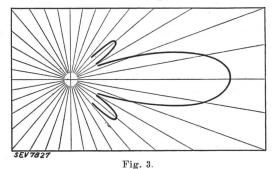
Richtungsdiagramm der Yagiantenne nach Fig. 3.
