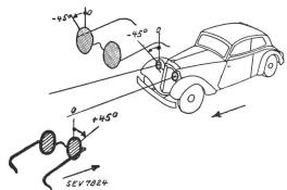
Fig. 2. Polarisationsebenen von Scheinwerfer und Brille.  $\longrightarrow$  Fahrrichtung.
