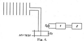
Schema des Oszillator-Modulators mit doppeladriger Speiseleitung für die Abstimmung mit der Antenne. Mit 1 ist der Oszillator-Modulator bezeichnet, während 2 Zwischenfrequenzverstärker, Detektor und Niederfrequenzverstärker darstellt.
