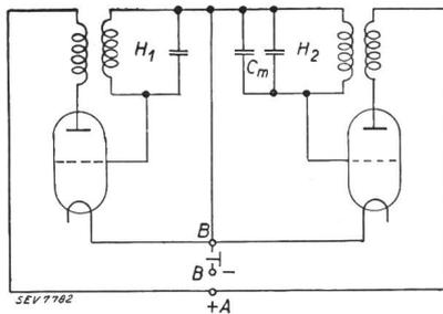
Fig. 6. Schaltung für die Schwebungsmethode. Cm Messkondensator.
