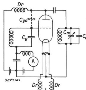
Fig. 8. Messung kleiner Kapazitätsänderungen mit der «Huth-Kühn-Schaltung».
