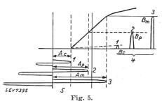
Amplification en régime C. Modulation de 100 % du courant anodique par une modulation de 50 % de la tension de grille. 1 Creux de modulation. 2 Intensités en porteuse. 3 Intensités en crète. 4 Courant anodique modulé à 100 %. 5 Excitation de grille, modulée à 50 %.
