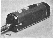
Description: Aspirateurs électriques de poussière selon figure. Ventilateur à force centrifuge entraîné par moteur série monophasé. Appareils munis de tube flexible, tubes de guidage et d'autres accessoires, utilisables pour aspirer et souffler.
