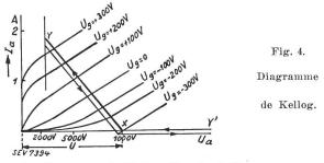
Le diagramme de Kellog (fig. 4) où l'on porte en ordonnée le courant  $(I_a)$  et en abscisse la tension plaque  $(U_a)$  pour différentes tensions de grille  $(U_a)$ , permet de trouver les valeurs instantanées du courant et de la tension plaques. On montre que le lieu de ces valeurs coïncide avec les segments rectilignes YXY'. La pente de XY est égale à l'inverse de la résistance Ra du circuit antirésonnant. Y est déterminé par le potentiel minimum d'anode et par le courant maximum de plaque.
