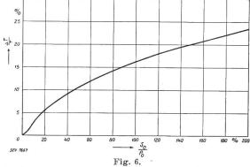
Stationäre prozentuale Temperatursenkung ( $\Delta T/T$ ) als Funktion der zusätzlichen, relativen Strahlungsleistung ( $S_0$ ), bezogen auf die Ofen-Nennleistung ( $P_0$ ) bei der Solltemperatur ( $T_0$ ) für starre Ofenspannung.  $S_0 = A \cdot \sigma \cdot T^4 \text{ in Watt.}$   $A \text{ sehwarz strahlende Fläche in cm}^2.$   $\sigma = 5.77 \cdot 10^{-12} \text{ W/cm}^2 \cdot \text{Grad}^4.$   $T \text{ abs. Temperatur in }^0 \text{ K.}$
