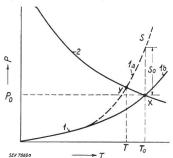
Fig. 5. Abhängigkeit der aufgenommenen Heizleistung (P) von der absoluten Ofentemperatur (T).
