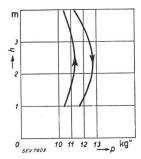
Fig. 22. Pression de contact (p) en fonction de la hauteur du patin audessus de la base du trolley (h).
