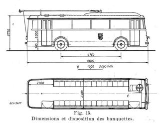
des banquettes est la même partout, même sur les caissons des roues, car l'essieu arrière est coudé et les roues sont munies d'un renvoi à engrenages. — Les entrées sont fermées par des portes à glissières commandées électropneumatiquement depuis le pu-
