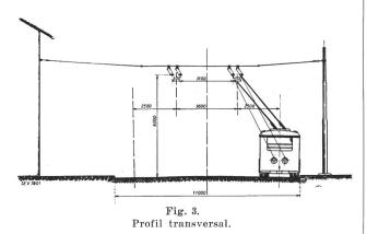
Cette ligne n'est normalement alimentée qu'en un seul point. Sa grande section (fil profilé CFF, 107 mm²) et 3 liaisons transversales maintiennent la chute de tension dans des limites admissibles.
