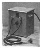
Description: Appareil selon figure pour la soudure électrique par bordage et bout à bout de minces tôles d'aluminium ou d'aliages d'aluminium. Transformateur à tension secondaire réglable (4 à 8 V). La soudure a lieu à l'aide d'électrodes de charbon que l'on guide le long des bords des tôles. Le passage du courant produit l'échauffement nécessaire des électrodes de soudure.
