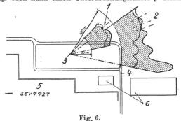
Durch Reflexion an den Flugzeugschuppen hervorgerufene Aufspaltung des Leitstrahls beim Flughafen Le Bourget, Paris. 1 Eine neutrale Zone. 2 Drei neutrale Zonen. 3 Bake. 4 Strasse. 5 Mauer. 6 Flugzeugschuppen.
