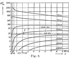
Feldstärke-Kurven entsprechend einer Flughöhe von 1000 m. Höhe des Dipols über dem Boden 30 m. Flughöhe 1000 m. Reichweite der optischen Sicht 124 km. Strahlungsleistung 1,75 kW. 1 Untere Grenze der für den Empfang nötigen Feldstärke.
