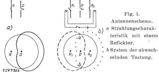
Das Prinzip der Methode wird durch die schematische Fig. 1 erläutert. Stellt man neben einen vertikalen Dipol einen gleich grossen, in der Mitte kurz geschlossenen Dipol als Reflektor, so resultiert im allgemeinen eine herzförmige Strahlungscharakteristik. Benutzt man zwei Reflektoren, die abwechselnd kurz geschlossen und wieder geöffnet werden,
