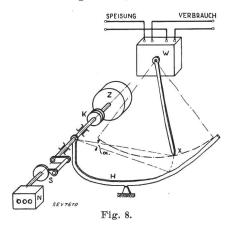
winkel  $\alpha$  für jeden durch das Wattmeter W angezeigten Leistungswert dem Leistungsquadrat proportional ist. Wenn der Impuls, welcher dem Hebel H vom Uhrwerk erteilt wurde, vorübergeht, wird der Hebel H durch das Eigengewicht oder durch eine Feder in seine Anfangslage zurückgebracht. Auch bei dieser Anordnung zeigt das Zählwerk die in Formel (4) auftretende Grösse N an.
