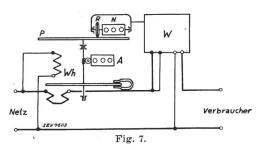
einflusst, dass das Uebersetzungsverhältnis zwischen der Zähleraxe und dem Zählwerk N zu jeder Zeit der Wirkleistung proportional ist. Durch das Zählwerk wird also eine dem Integral N [Formel (4)] proportionale Grösse angezeigt.
