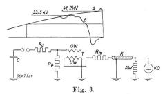
Versuchsspannung und erzeugte Stoßspannung.
