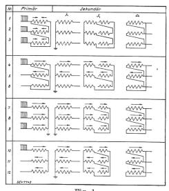
Fig. 1. Verhalten einiger Transformatorenschaltungen gegen Stoßspannungen.
