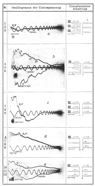
Fig. 2. Gemessene Stoßspannungen auf der Unterspannungsseite für einige Transformatorschaltungen.
