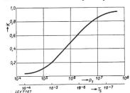
Fig. 17. Berechnete Abhängigkeit der kapazitiv übertragenen Teilspannung von der Steilheit der ankommenden Stoßspannung.
