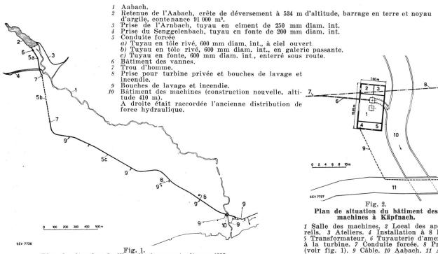
Fig. 1. Plan de situation de l'installation construite en 1882.
