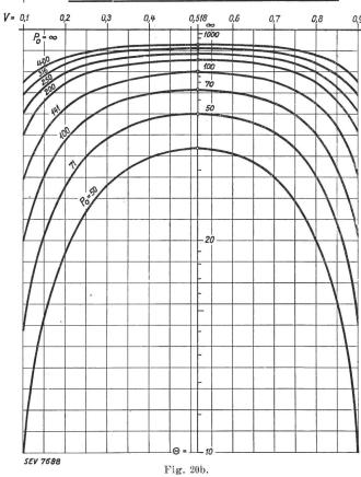
Fig. 20a. Fig. 20b. Verlauf von P in der Nähe der Resonanzstelle Verlauf von  $\Theta$  zwischen V=0,1 und 0,9 für praktisch vorkommende  $P_0$ -Werte (sehr guter Rundfunk-Schwingkreis:  $P_0\approx 200$ ).
