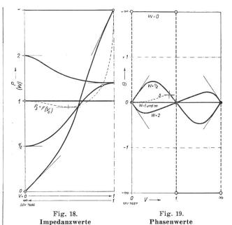
des symmetrischen Kreises mit der Dämpfung als Parameter. Die gestrichelte Kurve (s) stellt den geometrischen Ort der Serie-Resonanzpunkte dar (freie Eigenschwingung).
