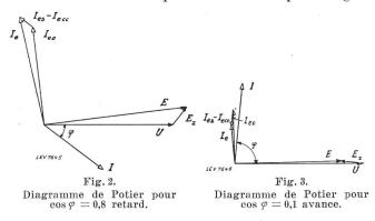
Ces calculs se font par l'intermédiaire de diagrammes vectoriels tels que par exemple celui de Potier  $^2$ ). Nous donnons ci-dessous deux exemples de ce diagramme (fig. 2 et 3), soit pour un alternateur fonctionnant sous un  $\cos\varphi=0.8$  retard, qui est le cas usuel des réseaux de distribution, soit pour le fonctionnement à  $\cos\varphi=0.1$  avance correspondant à l'alimentation d'un transformateur
