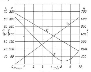
Fig. 13. Essai du groupe alternateur-transformateur  $U_2=30\,\,\mathrm{kV};\,\cos\varphi_2=0\,\,\mathrm{avance}.$
