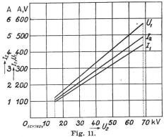
Courant maximum au secondaire du transformateur  $I_2=\mathbf{f}~(U_2)~\mathrm{pour}~U_2$  compris entre 15 et 68,5 kV  $I_0=0~\mathrm{cos}~\varphi_2=0$  avance.
