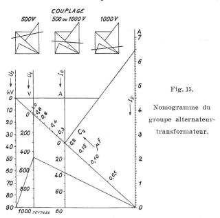
le courant d'excitation de l'alternateur pour le couplage 500 V et la capacité du câble en essai. Il suffit de joindre par une droite le point de l'échelle  $U_2$  avec celui de l'échelle  $I_2$  ou de l'échelle des capacités correspondant au cas envisagé pour obtenir par intersection avec les autres échelles les valeurs correspondantes. Selon la position de cette droite, on devra choisir l'un ou l'autre couplage, comme l'indiquent les petits diagrammes.
