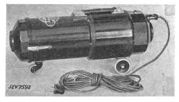
Description: Aspirateurs électriques de poussière selon figure. Ventilateur à force centrifuge, entraîné par moteur série monophasé. Boîtier en résine synthétique moulée. Tuyau souple de 2 m de long, tubes de guidage, différentes embouchures; appareils utilisables pour aspirer et pour souffler.
