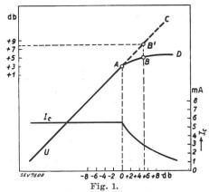
Caractéristique de l'amplificateur. Abscisses: Sortie de «l'amplificateur d'entrée». Ordonnées: Sortie de «l'amplificateur de sortie». I<sub>e</sub> courant de contrôle.
