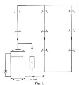
Warmwasserversorgungsanlage mit Zirkulationsleitungen und separatem Durchflussapparat (1) für die Zirkulation.
