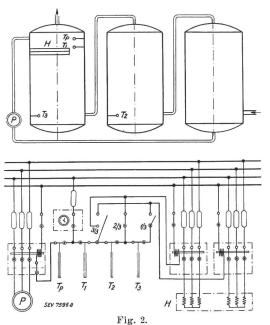
Magro-Speicheranlage. Beispiel für partielle Aufheizung und Stufenregulierung der Heizleistung.
