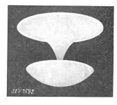
Description: Luminaire pour éclairage indirect. selon figure. Diffuseur (partie supérieure) et réflecteur avec coupe (partie inférieure) en tôle et fonte d'aluminium, avec peinture mate blanche appliquée au pistolet. Dans le réflecteur sont disposées 5 douilles de lampes en pentagone, destinées à re-cevoir des lampes de 60 W au maximum. Suspension du luminaire par rosette
