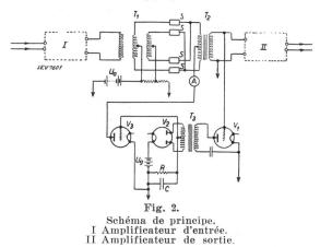
On remarque que chaque côté de la ligne comprend une résistance en série et une en parallèle; cette disposition permet de maintenir à des valeurs fixes l'impédance caractéristique pendant les changements de résistance des «varistors».
