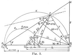
Diagramm des kapazitiven Spannungsteilers.
