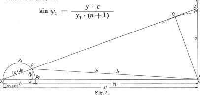
Diagramm des kapazitiven Spannungsteilers für U=60 kV (100-kV-Anlage),  $P_0=10$  kW,  $U_0=9.4$  kV, n=5,  $b=\infty$ , also ohne Drosselspule.
