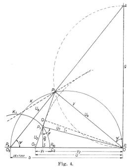
Diagramm des kapazitiven Spannungsteilers für  $U=60~{\rm kV}$  (100-kV-Anlage),  $P_{\rm g}=10~{\rm kW},~U_{\rm g}=9,4~{\rm kV},~\varepsilon=0,94,~n=5,~m=4.$
