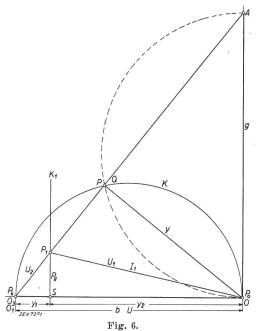
Diagramm des kapazitiven Spannungsteilers für  $U=60~{
