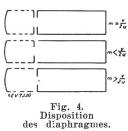
l'autre des deux cylindres d'un diaphragme conducteur (fig. 4). Une telle variété de dispositions peut être très ingénieusement réalisée dans un seul tube — figure 5 — où, en portant le diaphragme isolé central à des potentiels  $V_3$  égaux à  $V_1$  et  $V_2$ , ou compris entre  $V_1$  et  $V_2$ , on pourra réaliser toute une gamme de grossisements.
