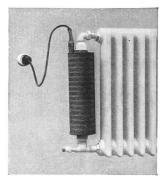
Description: Transformateur de chauffage (Semo-Trafo) pour radiateurs à eau. Le contenu d'eau du radiateur est chauffé par l'enroulement secondaire du transformateur, placé sur un tube qui de son côté est relié au radiateur. L'échauffement de l'eau produit la circulation dans le radiateur. Ces transformateurs peuvent être adaptés à des radiateurs avec une surface minima de 3 m² et peuvent servir de chauffage d'appoint à la mi-saison.
