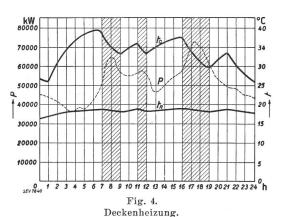
Temperaturverlauf bei den schraffierten Sperrzeiten:  $t_D$  an den Deckenoberflächen und  $t_R$  im Raum. P Wintertagbelastungsdiagramm des EW Zürich.
