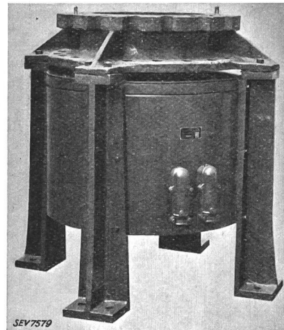
Fig. 6. Elektrisch beheizte Hochdruckautoklave.
