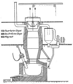
Fig. 1. Elektrischer Hochofen, System Grönwall.
